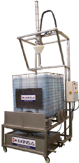
➤ Plataforma móvil para el apoyo del recipiente con una inclinación que facilita la evacuación de las aguas residuales.
