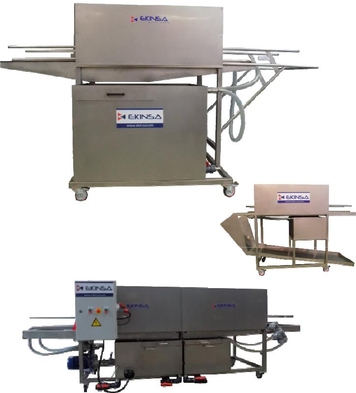
✓ Las **lavadoras de cajas EKINSA** son túneles de lavado y/o aclarados que están construidas íntegramente en acero inoxidable, lavando las cajas por dentro y por fuera.
