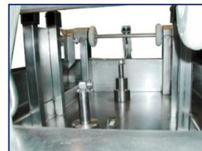
Con el modelo **MANUAL (1501)** el centrado de las barricas se debe realizar de forma manual, mientras que el modelo **AUTOMÁTICO (1502)** incorpora un sistema automatizado para el centrado
