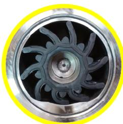
Sistema de **RODETE FLEXIBLE** de rotación única y patentado.
