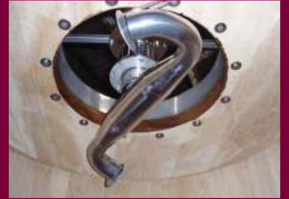
Aspersore Irroratore regolabile per rimontaggio in acciaio inox.
