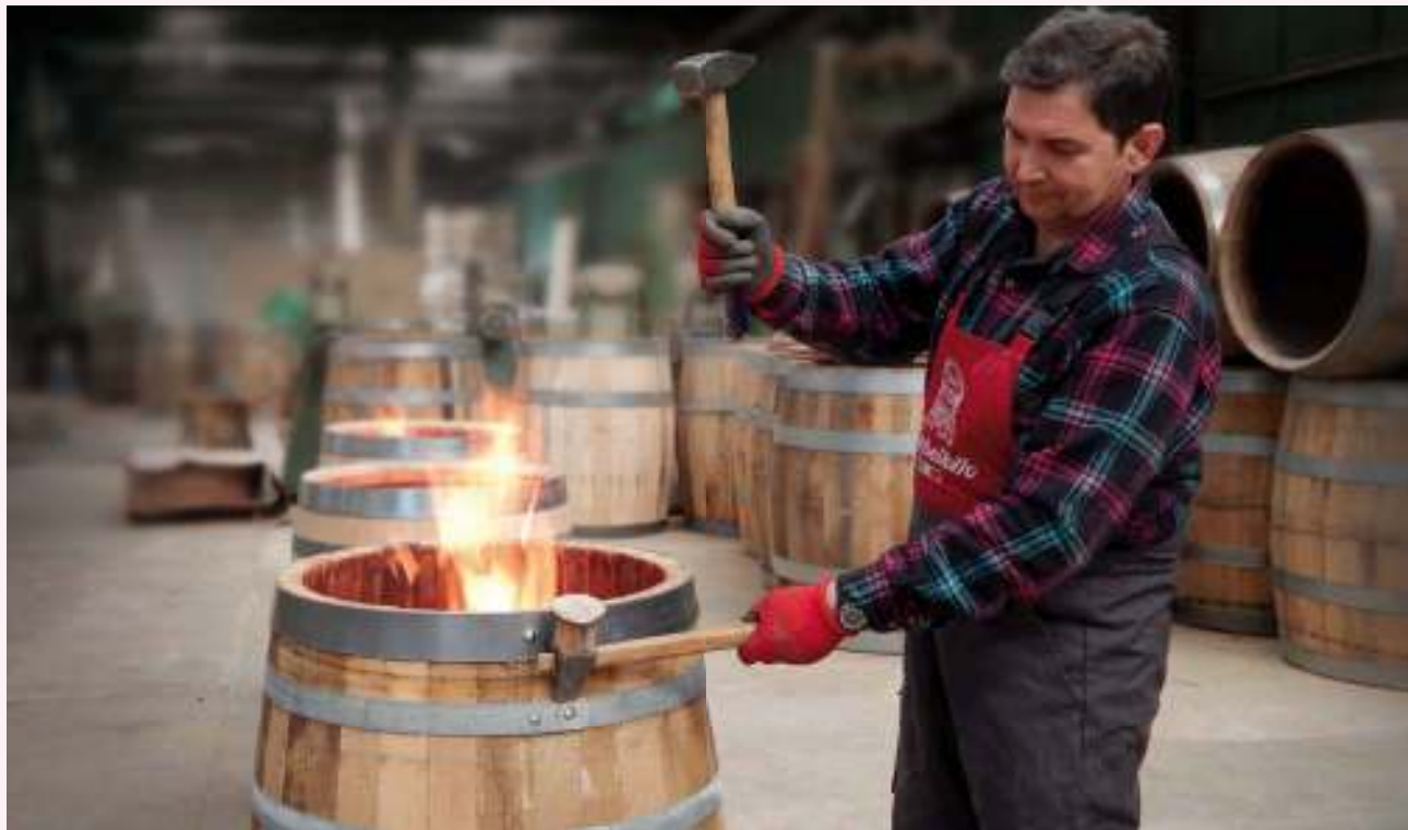
Piegatura a fuoco diretto e tostatura dei barili.
