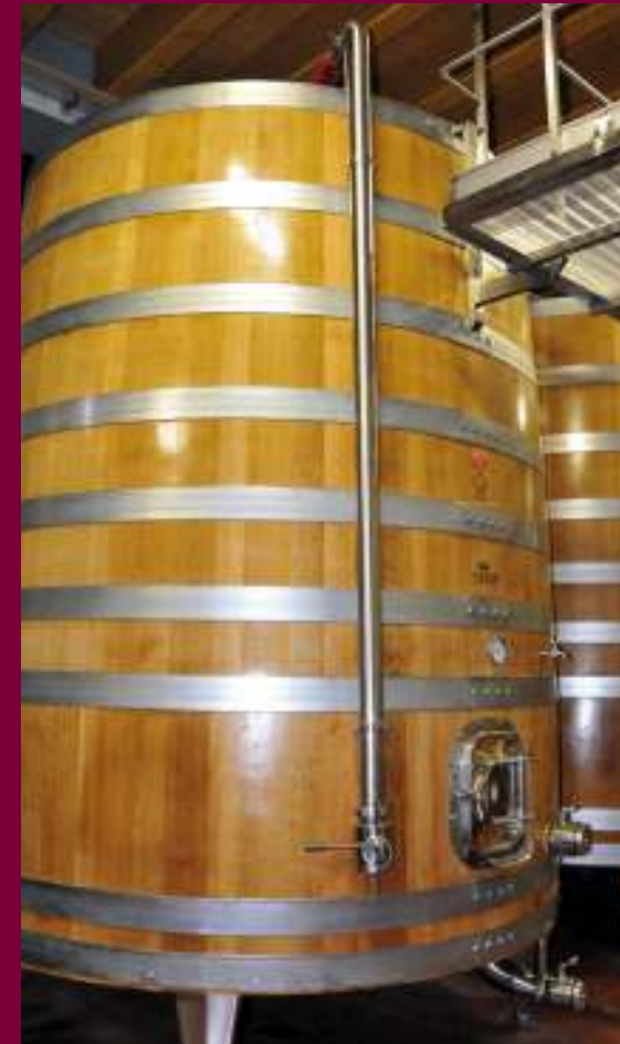
Gruppo di rimontaggio Gruppo di rimontaggio in acciaio inox per tini.
