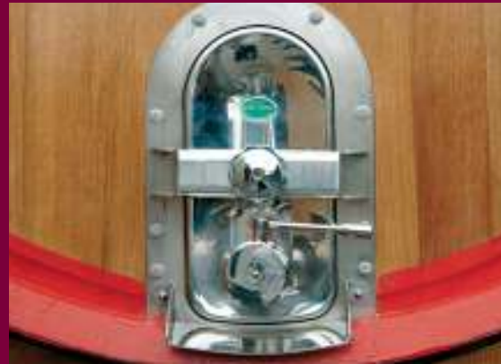
Portella in acciaio inox 18/8 AISI 304 Di dimensione 24 x 46 cm a passo d'uomo, completa di valvola a piacere. Inserita a regola d'arte in un'unica specialissima doga centrale del fondo.
