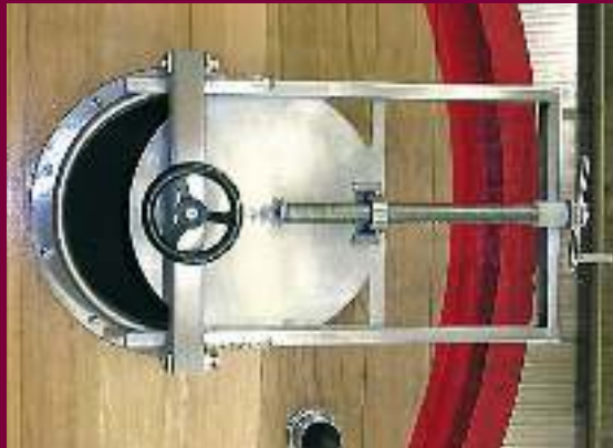
Portella a ghigliottina in acciaio inox 18/8 AISI 304 Utilizzata per scarico vinacce, applicata al fondo inferiore.
