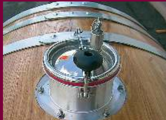
Chiusino superiore al cocchiame in acciaio inox 18/10 AISI 316 Dimensioni da 16 cm o 22 cm di diametro, alto 9 cm, completo di valvola di sovrappressione in acciaio.
