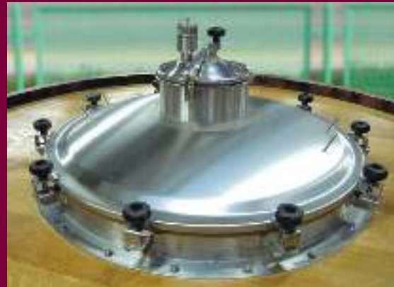
Chiusino in acciaio inox 18/10 AISI 316 bombato verso l'esterno Di dimensione proporzionale al diametro del tino, da 40 a 120 cm. Disponibile in due versioni: con foro al centro e relativo colmatore o con camino di sfiato da 22 cm completo di valvola di sovrappressione.
