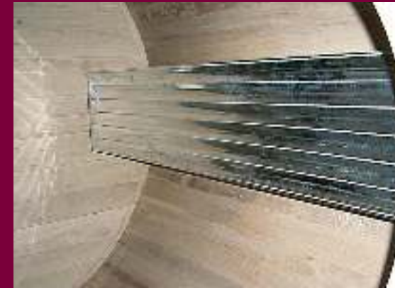
Gruppo di termo-condizionamento Formato da piastre in acciaio inox 18/10 AISI 316 a doppia saldatura e pozzetto sonda. Installabile sia orizzontalmente che verticalmente rispetto all'altezza del tino. Una piastra ogni 50 hl di capacità.
