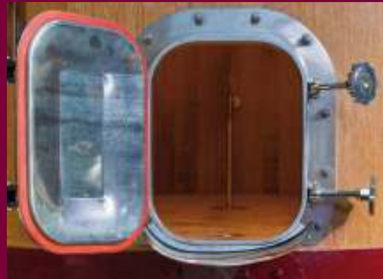
Portella in acciaio inox 18/8 AISI 304 a filo-fondo Dimensione 31 x 42 cm a passo d'uomo, con apertura verso l'esterno.
