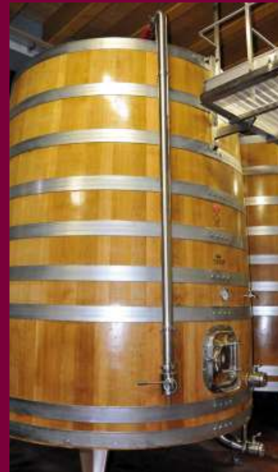
Gruppo di rimontaggio Gruppo di rimontaggio in acciaio inox per tini.
