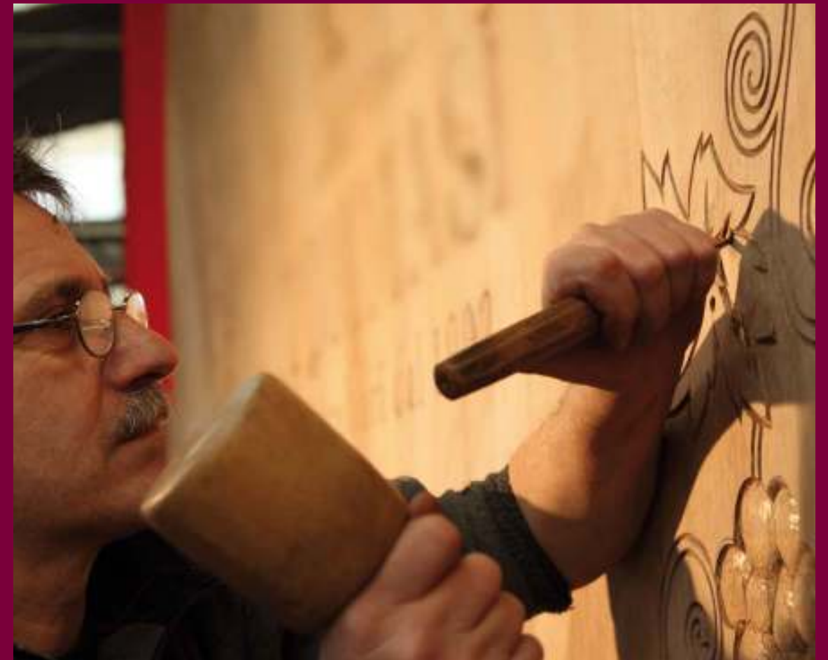
Intaglio a mano Le botti inoltre si possono personalizzare con l'esclusivo intaglio al fondo anteriore, realizzato interamente a mano.
