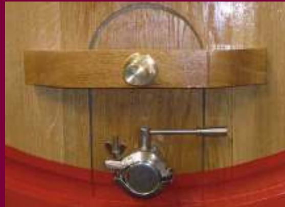
Portella di legno con guarnizione in silicone Inserita in un'unica doga centrale, completa di vite in AISI, cappellotto in ottone
