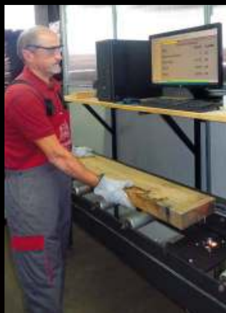
Selezione computerizzata NearInfrared degli aromi del legno.
