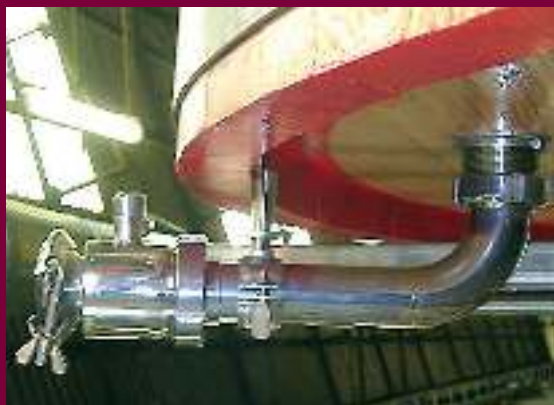
Gruppo di scarico totale in acciaio inox 18/8 AISI 304 Completo di valvola finale a piacere, applicato a regola d'arte in un'unica dogia centrale del fondo del tino.
