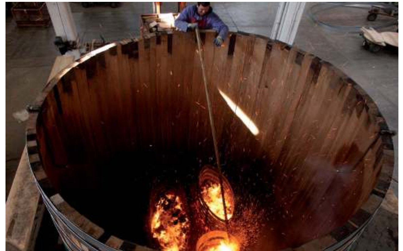
Tostatura delle doghe di Magnifica , 333 hl di capacità (Guinness dei primati '10, per la botte d'affinamento più grande al mondo).
