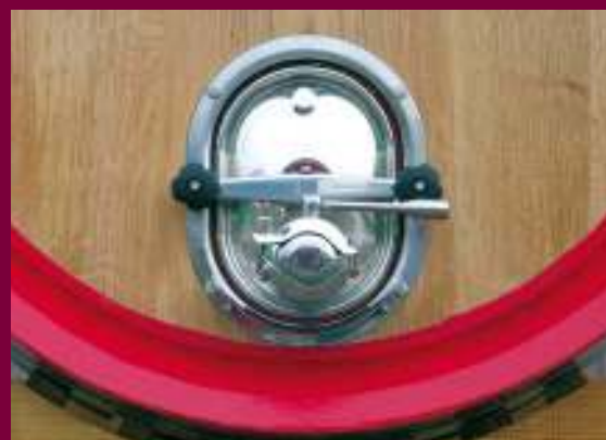
Sportellino in acciaio inox 18/8 AISI 304 (per botticelle) Di dimensioni 19 x 26 cm, inserito a 3 cm dalla testa delle doghe, completa di valvola in acciaio.
