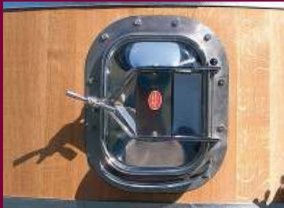
Portella in acciaio inox 18/8 AISI 304 Applicata a 30 cm dal fondo base. Dimensione 31 x 42 cm a passo d'uomo, con apertura verso l'esterno.
